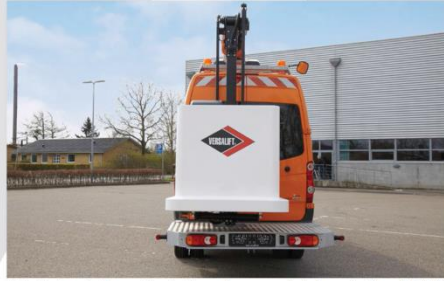
Zadná nástupná plošina (asymetricky uložený kôš)
